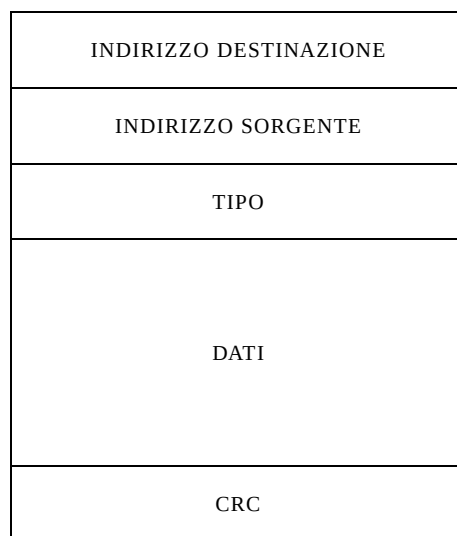
Figura 5.27. Formato della PDU a livello data link
